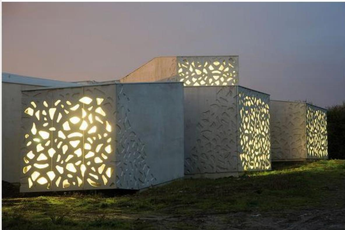
Изготовление таких панелей сродни набивке рисунка на ткани: сначала изготавливаются деревянные матрицы, покрытые полимером, причем использовать каждую из них можно лишь единожды.
